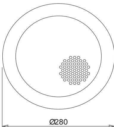
1. Der für den RNS 8/T benötigte Deckenausschnitt beträgt 244 mm/Durchmesser.
