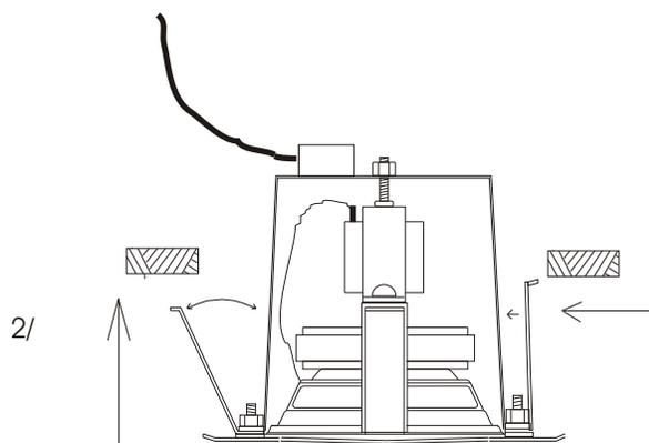
**2. Montage des Lautsprechers erfolgt durch Andrücken Der Edelstahl-Blechfedern in den Feuertopf. Danach den Lautsprecher weiter in den vorbereiteten Ausschnitt einführen.**
