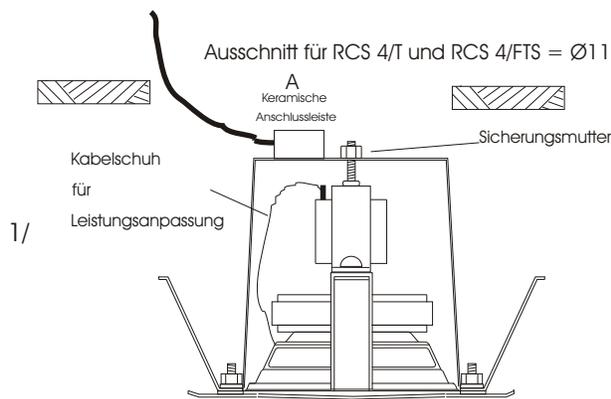
**1. Drähte an keramische Anschlussleiste anschließen (siehe Zeichnung - „A“). Der Lautsprecher ist auf halbe Leistung, 2 Watt, werkseingestellt. Sollte eine höhere oder niedrigere Anpassung benötigt werden, entfernen Sie, bitte die Sicherungsmutter und den Feuertopf, um den 100 V Übertrager zu entfernen. Um die Leistung zu ändern, wechseln Sie die Steckverbindung zur benötigten Wattleistung. Siehe unten Leistungsanschlussbelegung:**
